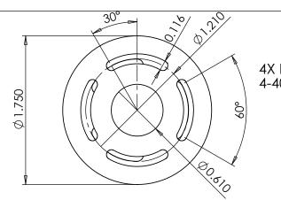
4X EQUALLY SPACED 4-40 CLEARANCE SLOTS
